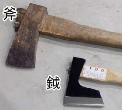
左の写真の上が斧で、下が鉄です。ヘッドの形状が違っていますね。当社は暖炉があるため、薪割りに使う斧が年季入っています(^^)斧は薪を割るのに、そして鉄は木を削るのに向いています。鉄で薪を割ることもできますが、刃の下の方に當てるとヘッドが抜けたりするので注意！！！
