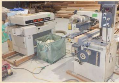
▲左が『プレーナー（自動カナナ盤）』、仕上げを行います。右が『溝突き機』、溝をつけてくれる機械です。
