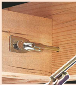
羽子板 小屋梁と軒桁、軒桁と柱、胴差と床梁及び通し柱と胴差の接合に使用します
